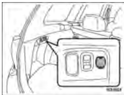
Prise de courant dans l'espace de chargement
